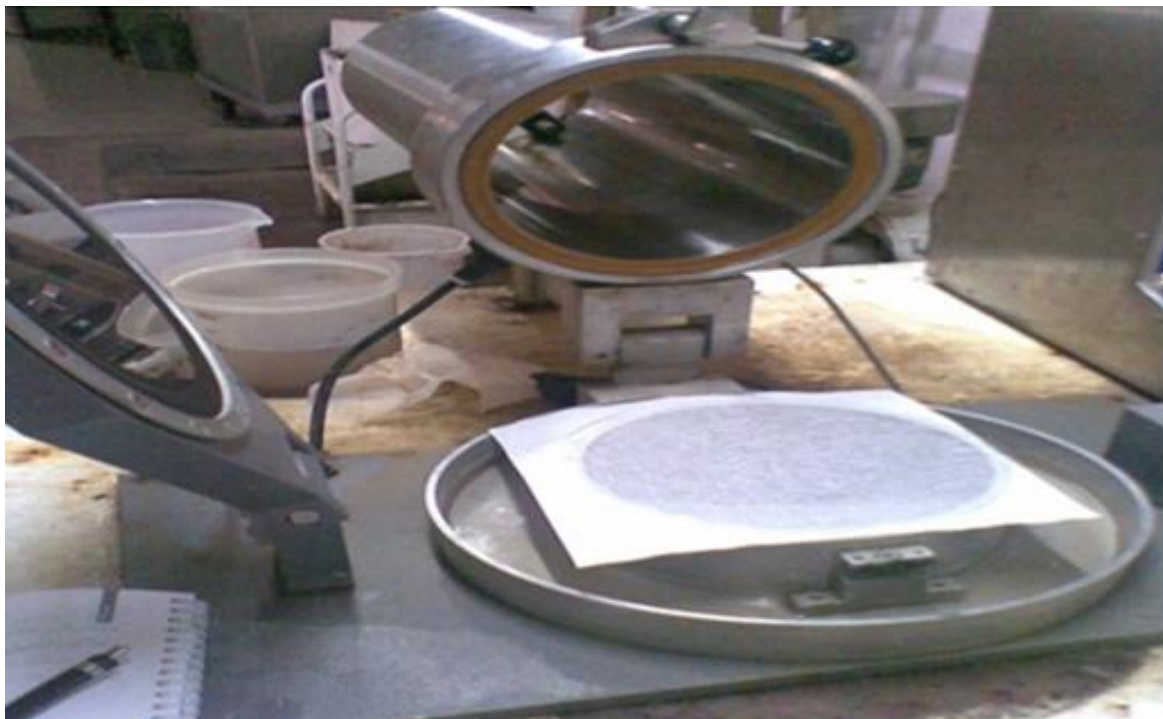
شکل (۹-۳) ته نشین شدن یکنواخت خمیر در دستگاه هندشیت ساز- محلول در این بشر به صورت یکنواخت ته نشین میشود و بعد از چند ثانیه، آب تخلیه میگردد و خمیر ته نشین شده، هندشیت ساخته میشود
