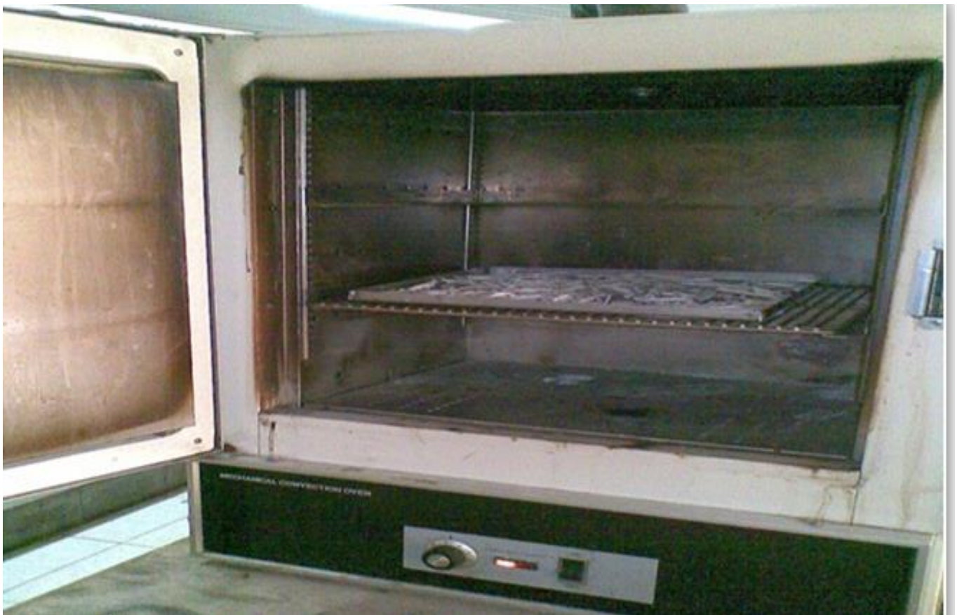
شکل (۴-۶) قطعات خرد شده ی ساقه ی گیاه آقطی در دستگاه speed dryer قرار داده شد که پس از ۳۰ دقیقه خشک گردید. (مرحله اول- شماره دو)
