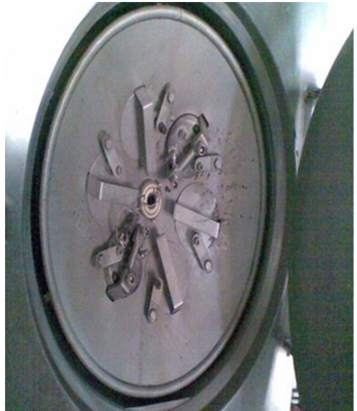
شکل (۶-۱۲) قرار دادن مخزن های هرکدام از دو پخت سودا و کرافت در دستگاه Digester.
