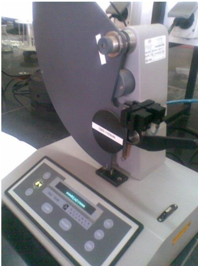
شکل (۱۰-۶) دستگاه تعیین مقاومت پارگی کاغذ (tear strength tester)
