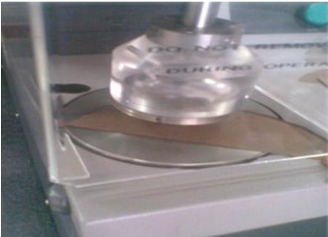
شکل (۲-۱۰) با ایجاد حالت مکش توسط دستگاه، مقاومت ترکیدگی کاغذ تعیین میگردد.
