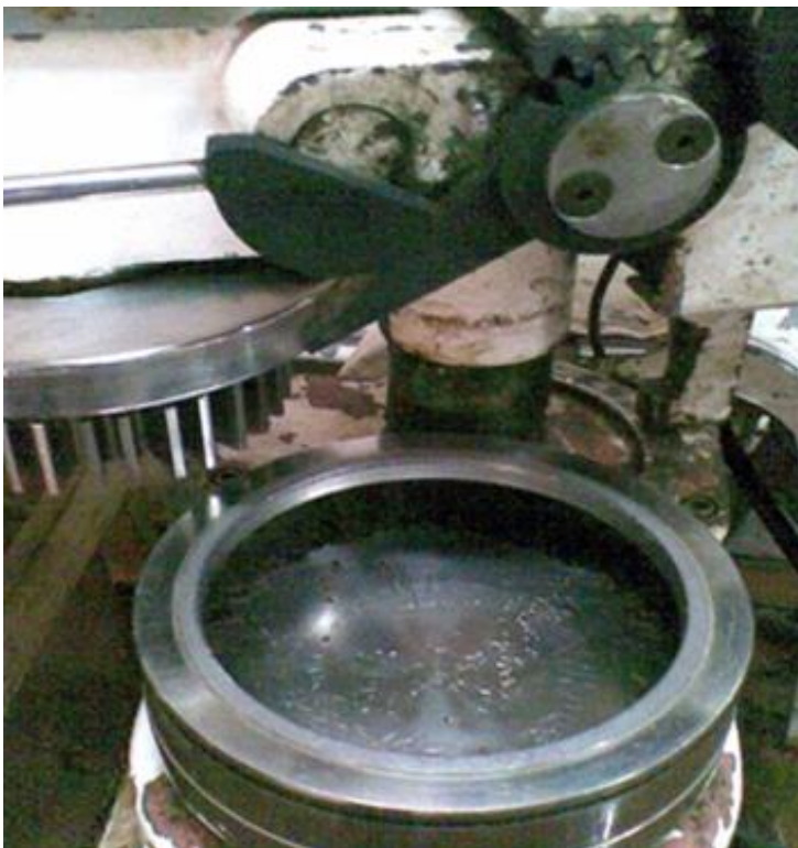
شکل (۷-۱۹) خمیر را به طور کامل به دیواره ی دستگاه پالاینده میچسبانیم.
