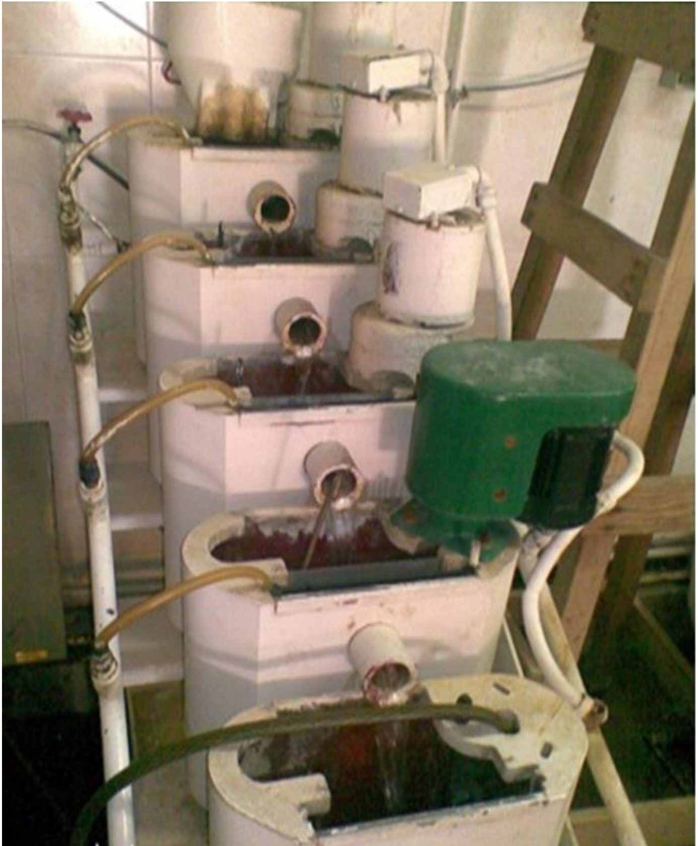
شکل (۸-۱) دستگاه کلاسه بندی- دستگاه کلاسه بندی دارای ۴ تانک است. از محفظه ی بالایی دستگاه، محلول حاوی خمیرار تانک بالایی داخل دستگاه ریخته میشود. هر محفظه دارای مش هایی حاوی منافذ است. از بالا به پایین، منافذ مشها ریزتر میشود و از بالا بترتیب R14-R28-R48-R100 است.
