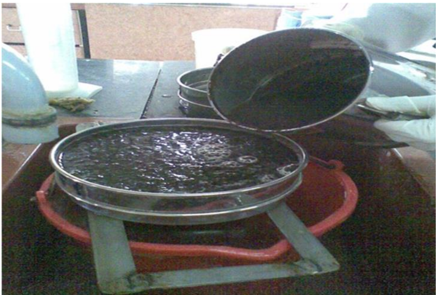
شکل (۷-۱۱) آبگیری چیپسها . محتویات دستگاه Desintegrator را در داخل صافی میریزیم و چیپسها را آبکشی مینمائیم.
