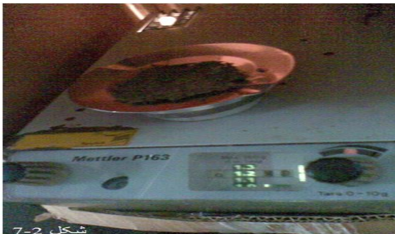
شکل (۸-۳) ترازوی دیجیتال- برای تعیین اندازه ی الیاف، بعد از کلاسه بندی هرکدام از دو پخت کرافت و سودا، آنها را در Speed Dryer قرار داده شدند تا پس از خشک شدن، وزن آنها با ترازوی دیجیتال اندازه گیری شود.
