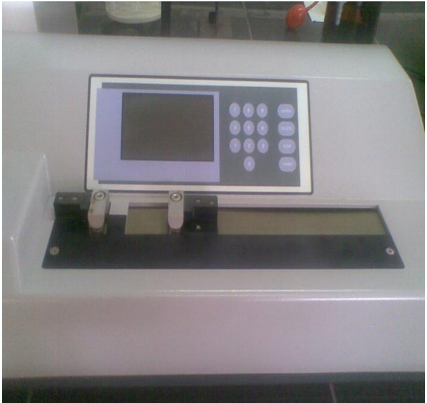
شکل (۴-۱۰) دستگاه تعیین مقاومت کششی (tensile strength) -برشهای طولی کاغذها، که از روی الگوی برش، بدست آمده اند را در دستگاه قرار میگیرد. دستگاه، توسط بازوی خود، کاغذ را آنقدر میکشد تا در یک نقطه پاره شود. آنگاه عددی بر روی دستگاه بر حسب Km مشاهده میشود.
