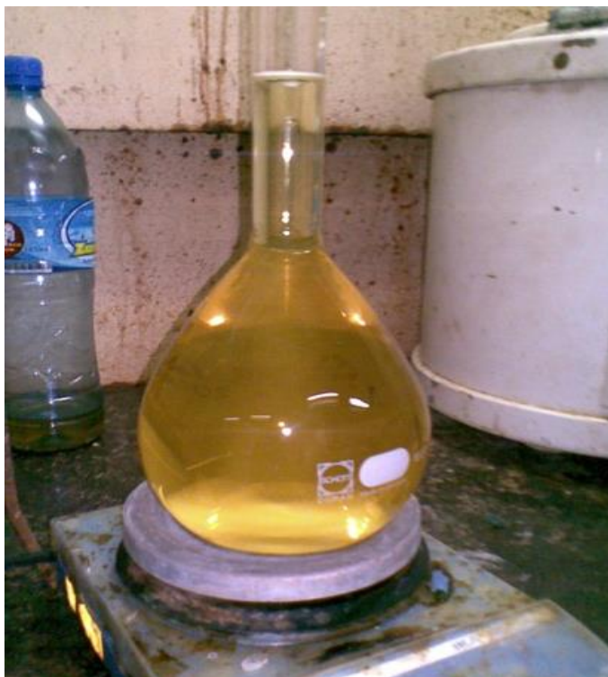
شکل (۵-۶) مایع پخت (لیکور سفید) شامل ترکیبی از \text{Na}_2\text{S} + \text{NaOH} است. (مرحله دوم)
