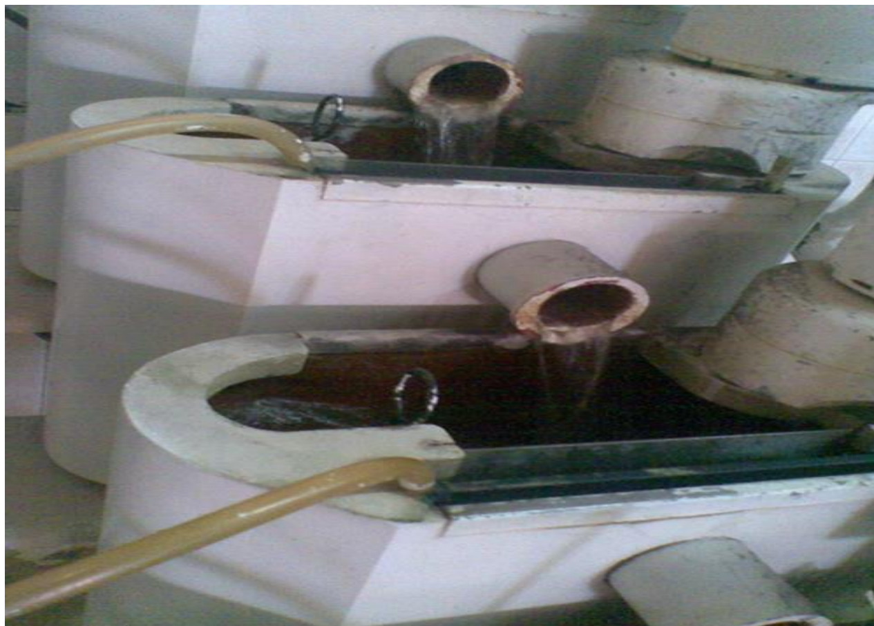
شکل (۸-۲) دستگاه کلاسه بندی - خمیر عبور کرده از کلیه مشها، P100 یا همان هدر- رفت نام دارد که شامل الیاف خیلی ریز (fine) است
