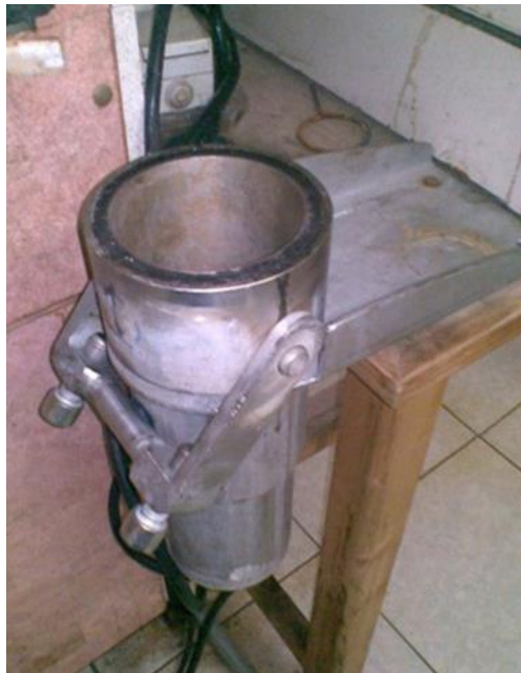
شکل (۱۴-۶) مخزن پخت Digester برای پخت سودا
