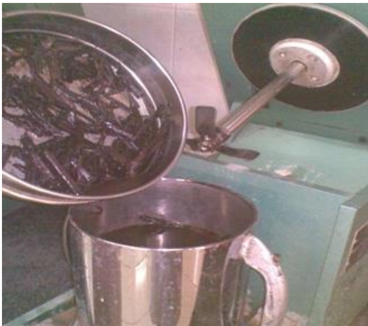
شکل (۷-۱۰) چیپسها را داخل دستگاه Desintegrator میریزیم
