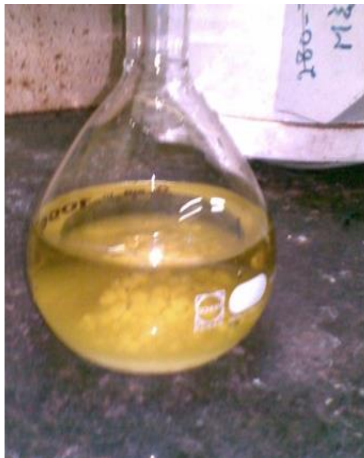
شکل (۶-۱۱) اضافه کردن فرمالین به تیتراسیون مایع پخت.
