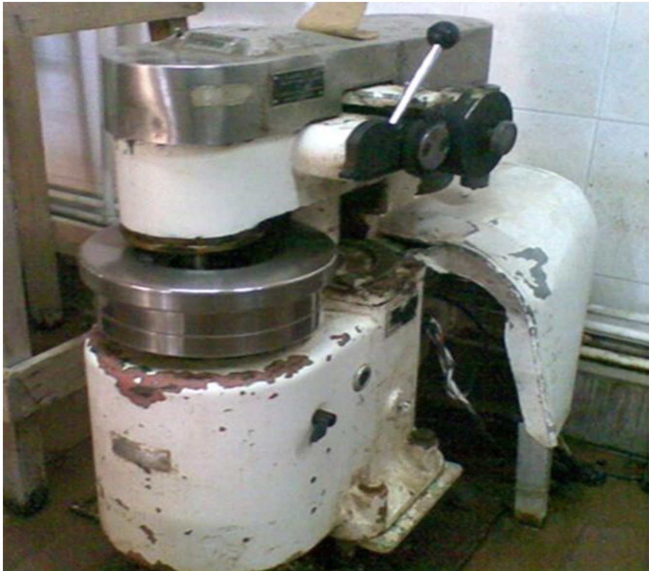
شکل (۷-۱۸) دستگاه پالاینده (PFI) برای پالایش هریک از خمیر های پخت کرافت و سودا.
