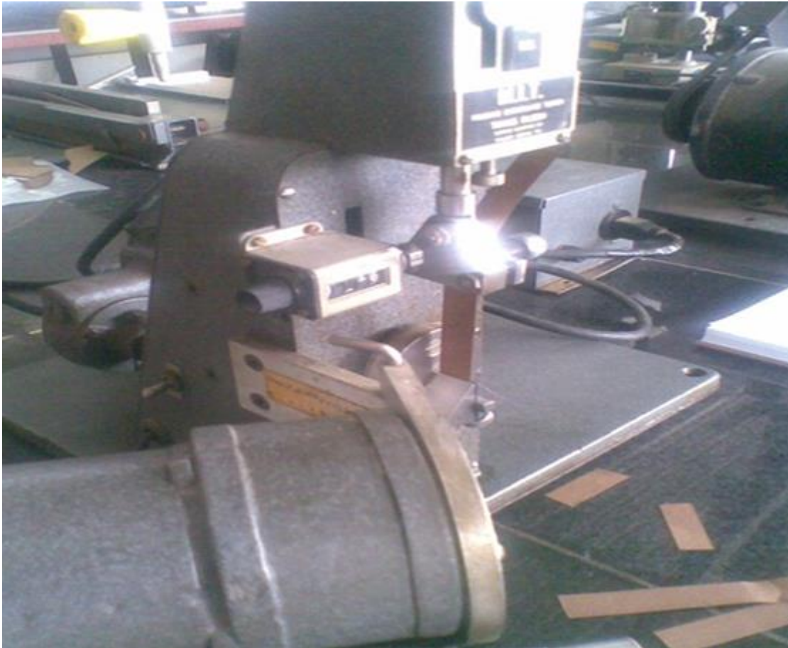
شکل (۷-۱۰) دستگاه تعیین مقاومت تاشویی کاغذ (folding endurance tester) - این نیرو بر روی کاغذ توسط حرکات چپ و راست بازوی دستگاه انجام میشود. دستگاه نیرویی معادل یک کیلوگرم به کار میبرد تا کاغذ را چندین بار تا کند
