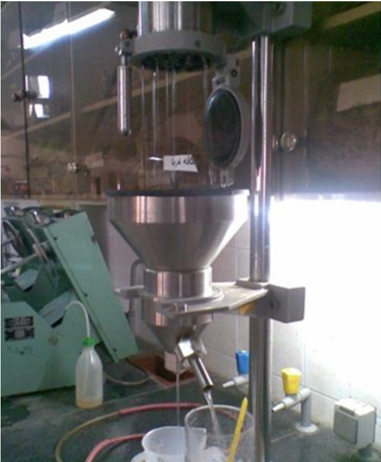
شکل (۷-۱۷) ریختن سوسپانسونها در دستگاه تعیین فرنیس.
