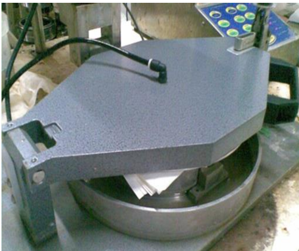
شکل (۹-۴) دستگاه Hand-sheet ساز. در این دستگاه آبیگیری اولیه از خمیر انجام میشود.
