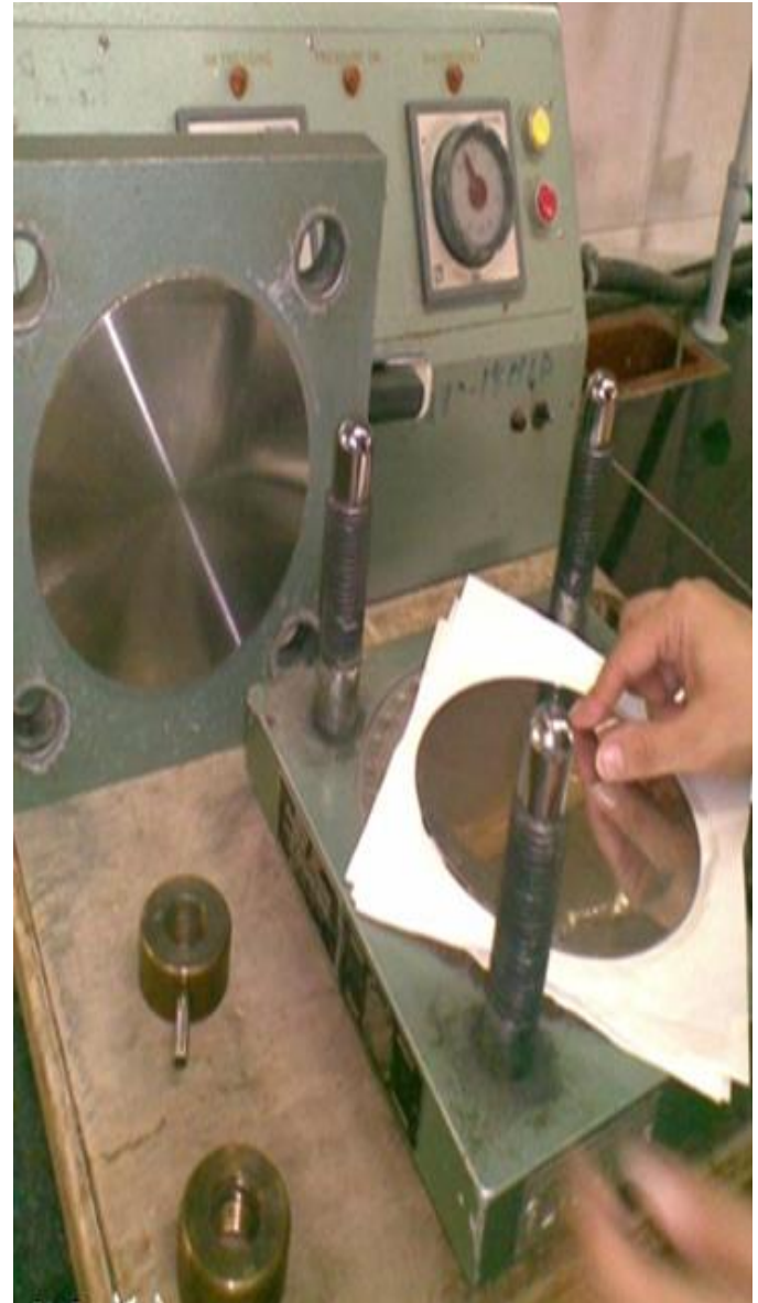
شکل (۹-۵) دستگاه پرس. برای آگیری بیشتر، sheet را بین دو صفحه ی آهنی قرار داده، به دقت در دستگاه پرس میگذاریم.
