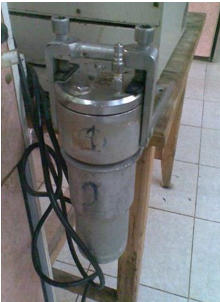
شکل (۱۵-۶) مخزن پخت Digester برای پخت کرافت
