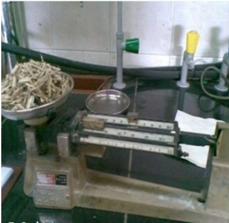
شکل (۳-۶) توزین چیپسهای تر قبل از خشک کردن. (مرحله ی اول - شماره یک)
