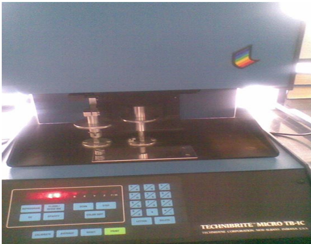
شکل (۸-۱۰) دستگاه تعیین شفافیت کاغذ (brightness tester)- چند برگ از نمونه ی کاغذ مورد نظر را از بالا به پائین زیرورو کرده و برای گرفتن در دستگاه Brightness قرار داده میشود.
