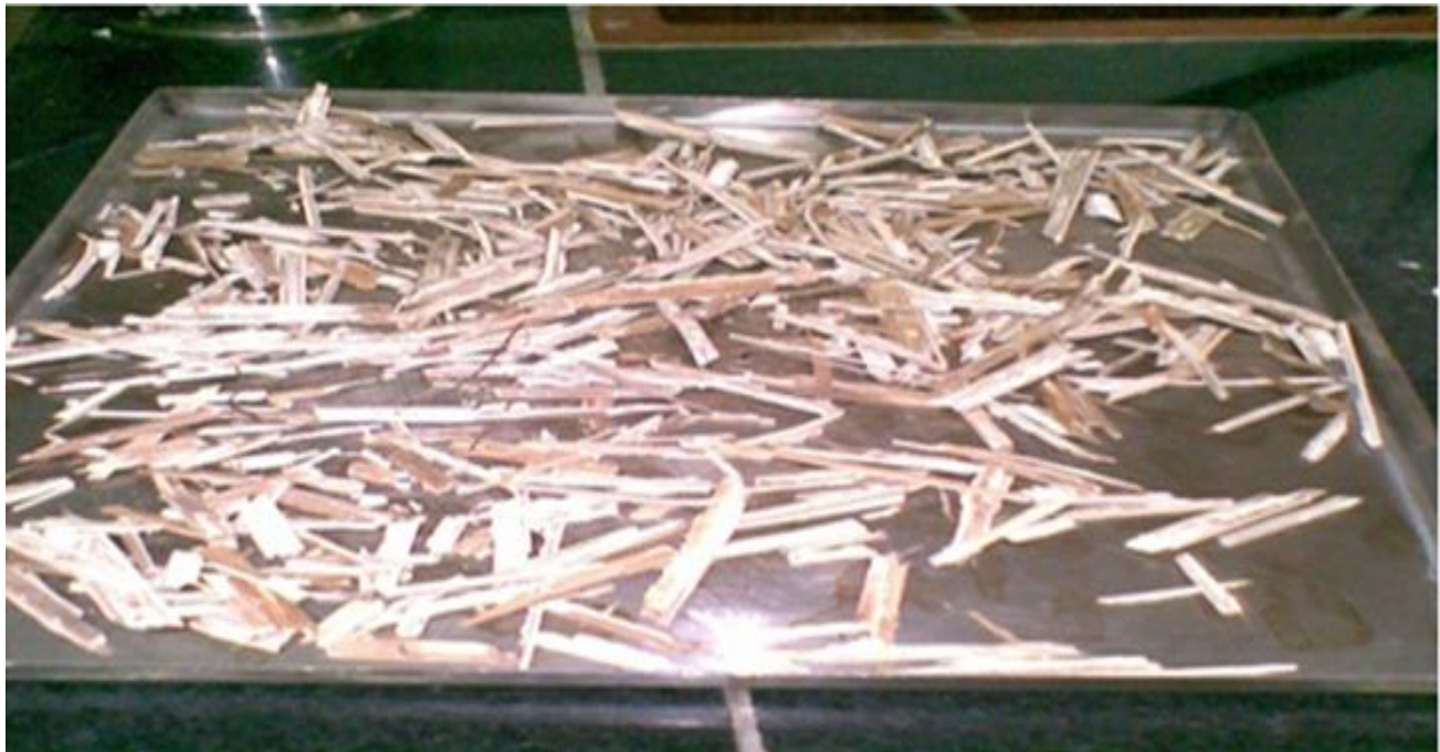
شکل (۶-۱) تهیه چپیس های خالص چپیس های خالص از خرد کردن ساقه ی خشک شده و پوست کندن مکانیکی گیاه آفتی که توسط نویسنده ی پایان نامه جمع آوری شده، بدست آمد.
