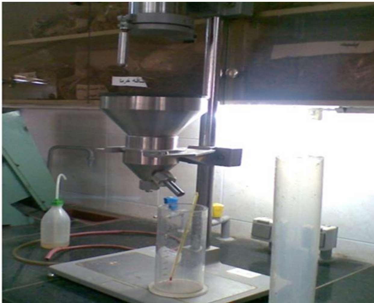
شکل (۷-۱۶) قرار دادن سوسپانسیون هریک از خمیرهای پخت یودا و کرافت در دستگاه تعیین فرینس، برای تعیین فرینس یا درجه ی روانی خمیر.
