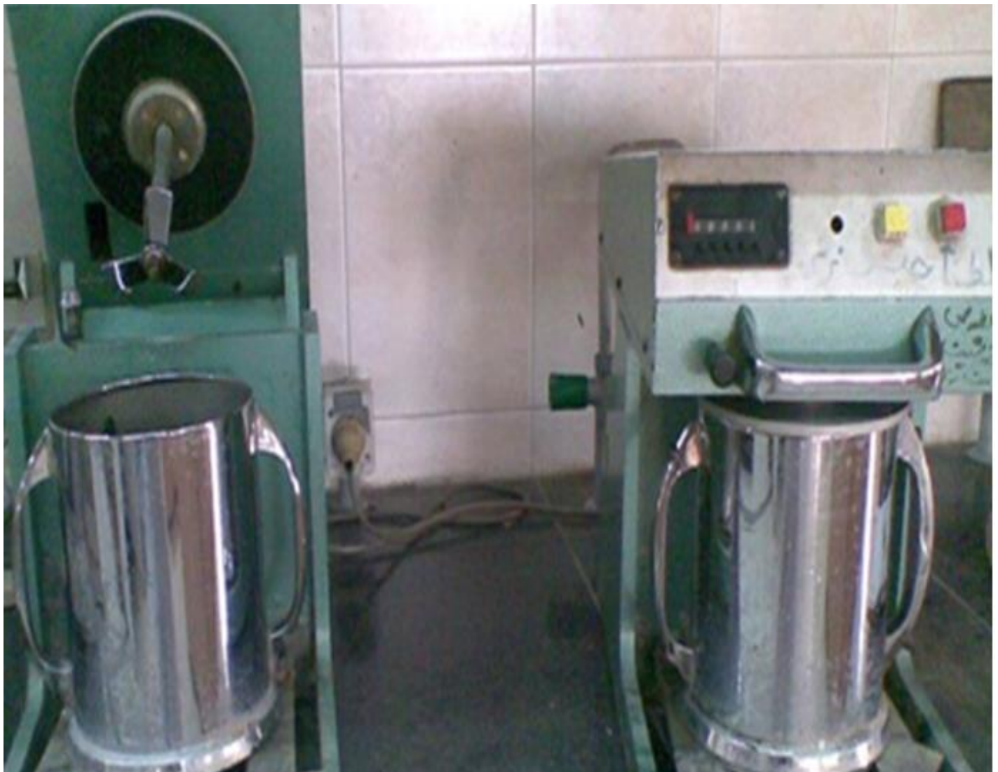
شکل (۷-۸) چپسها به مدت ۲۰ دقیقه با دستگاه Desintegrator (جدا کننده) جداسازی گشته، بیشتر خرد میگردند.
