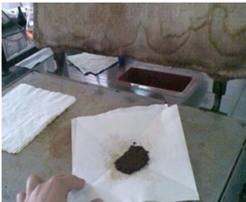
شکل (۷-۱۵) قرار دادن خمیرها در دستگاه speed dryer برای خشک شدن و سپس وزن کردن.
