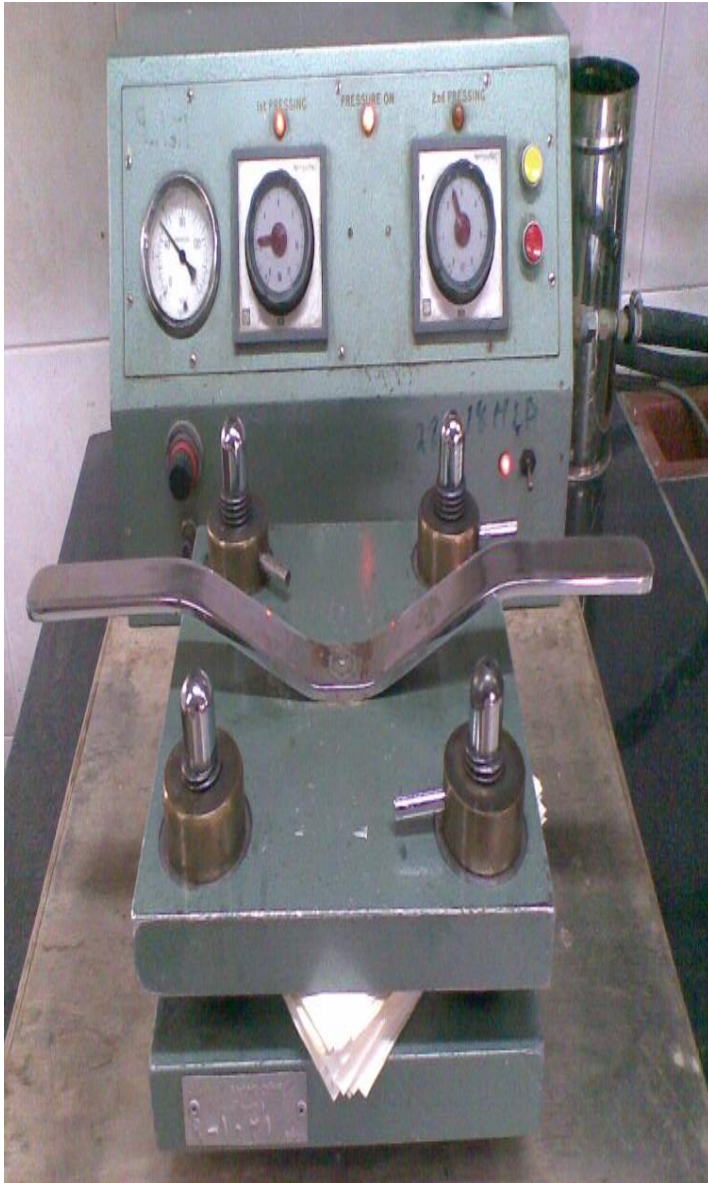
شکل (۹-۶) دستگاه پرس- دستگاه پرس دارای دو صفحه ی آهنربایی است. با این روش، برگه ها سریعتر و بهتر پرس میشوند.
