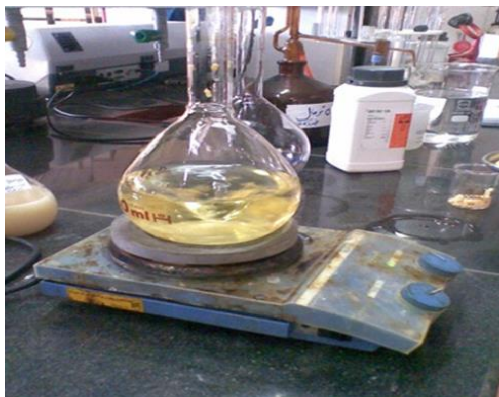
شکل (۶-۸) شماره ۳، پخت مایع پخت - مخلوط کردن آب و سود در ارلن ۲۰۰ میلی لیتر با همزن برقی.
