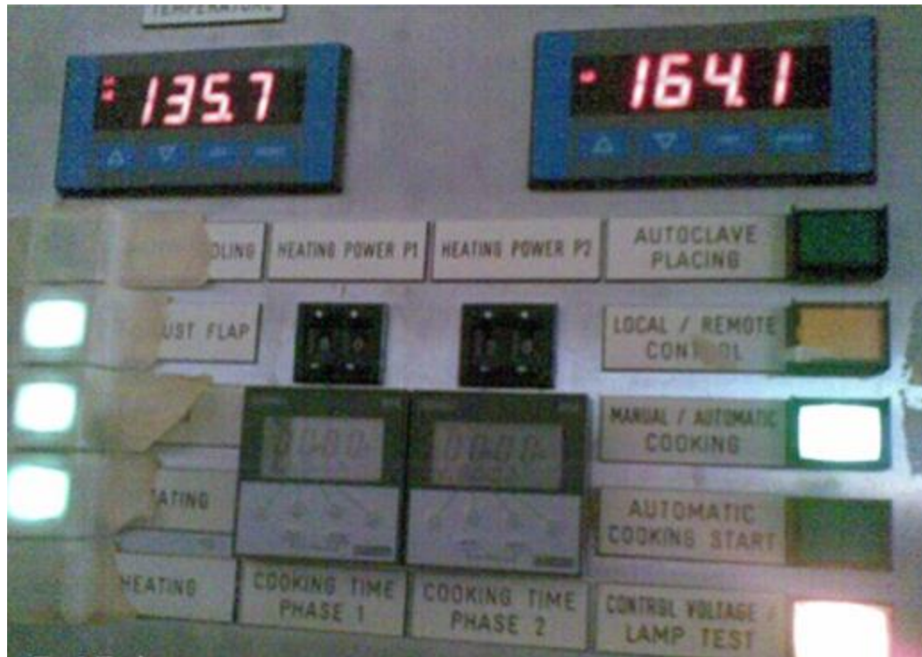
شکل (۱۶-۶) صفحه ی نمایش Digester برای نشان دادن دما و زمان
